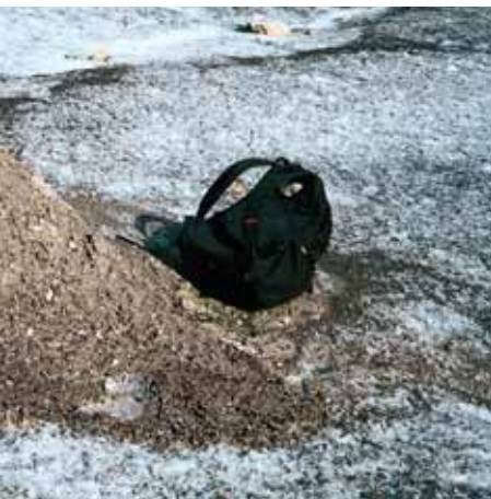
Aufnahme vom 16. September 2002: einer der drei «experimentellen» Sandkegel. Höhe 50 cm, Grunddurchmesser 85 cm
